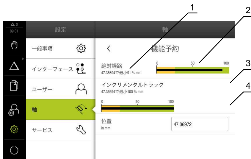
図 31: 測定プローブの機能リザーブの例
