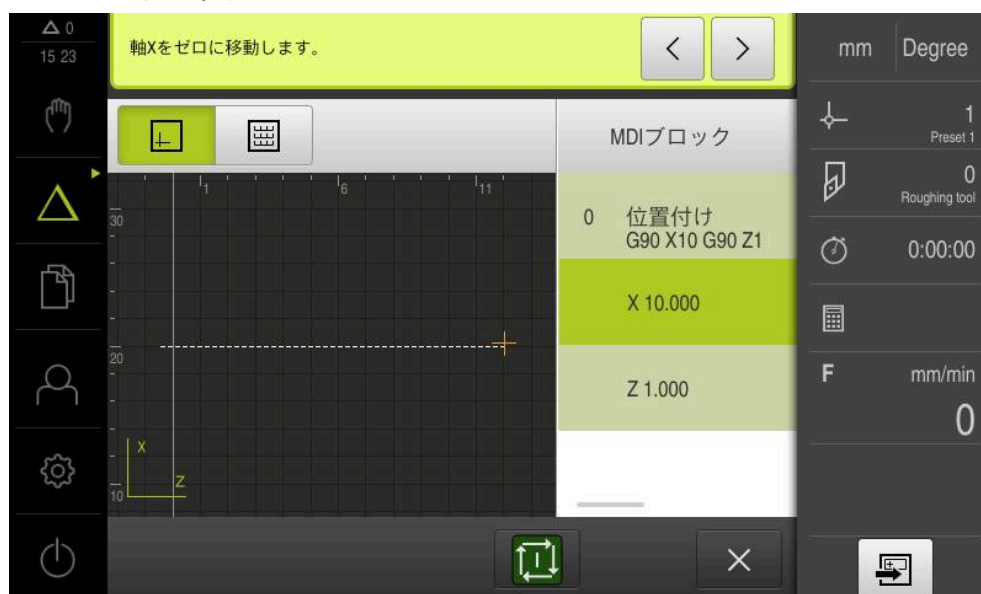
図 48: 例- スケーリングを使った MDI ブロックの実行
