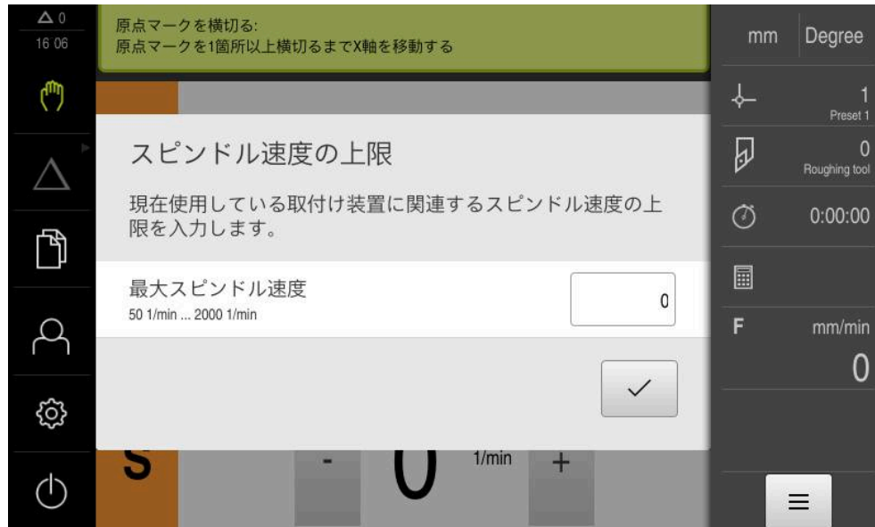
図 41: 「スピンドル速度の上限」ダイアログボックス
