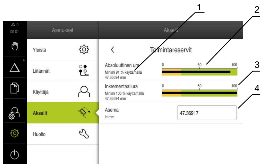
Kuva 31: Esimerkki kosketusanturin toimintareserveistä
