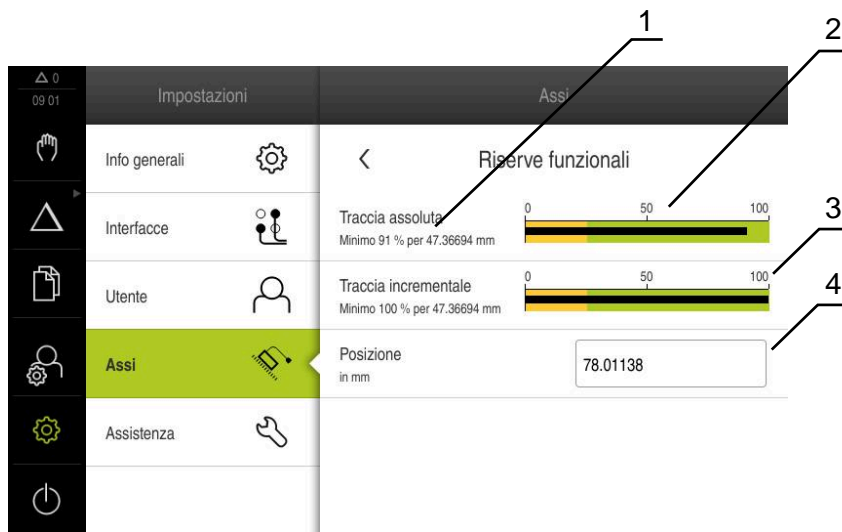
Figura 31: Esempio di riserve funzionali di un tastatore di misura
