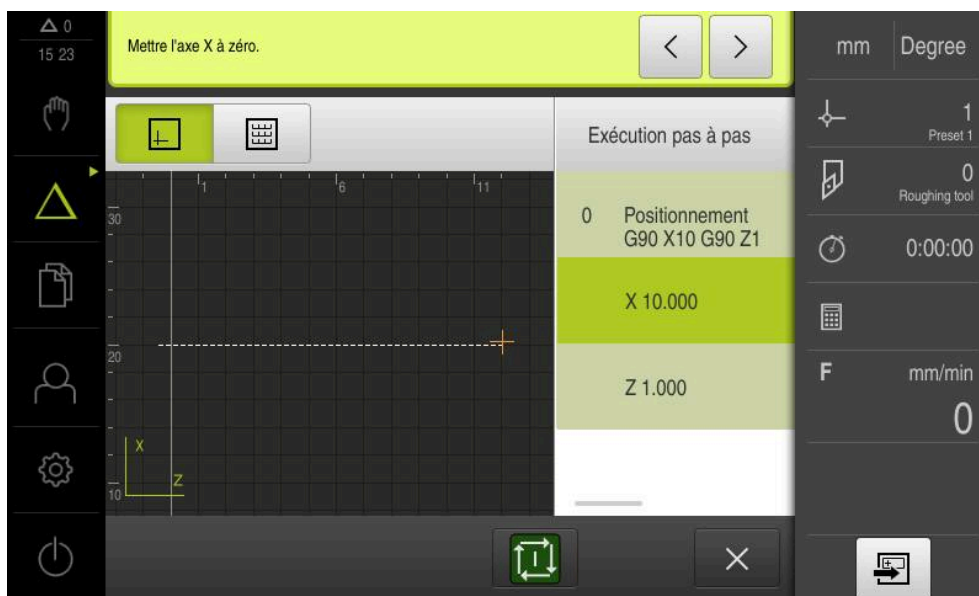
Figure 48 : Exemple – Exécution d'une séquence MDI avec un facteur d'échelle
