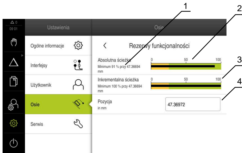
Ilustracja 44: Przykład rezerw funkcjonalności czujnika pomiarowego
