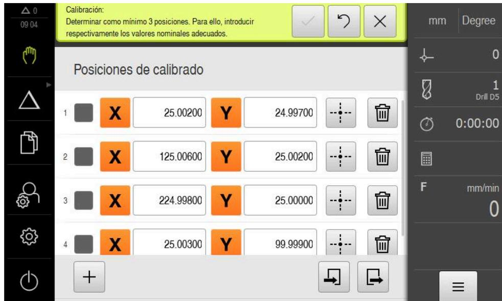
Figura 36: Paso **Posiciones de calibrado**
