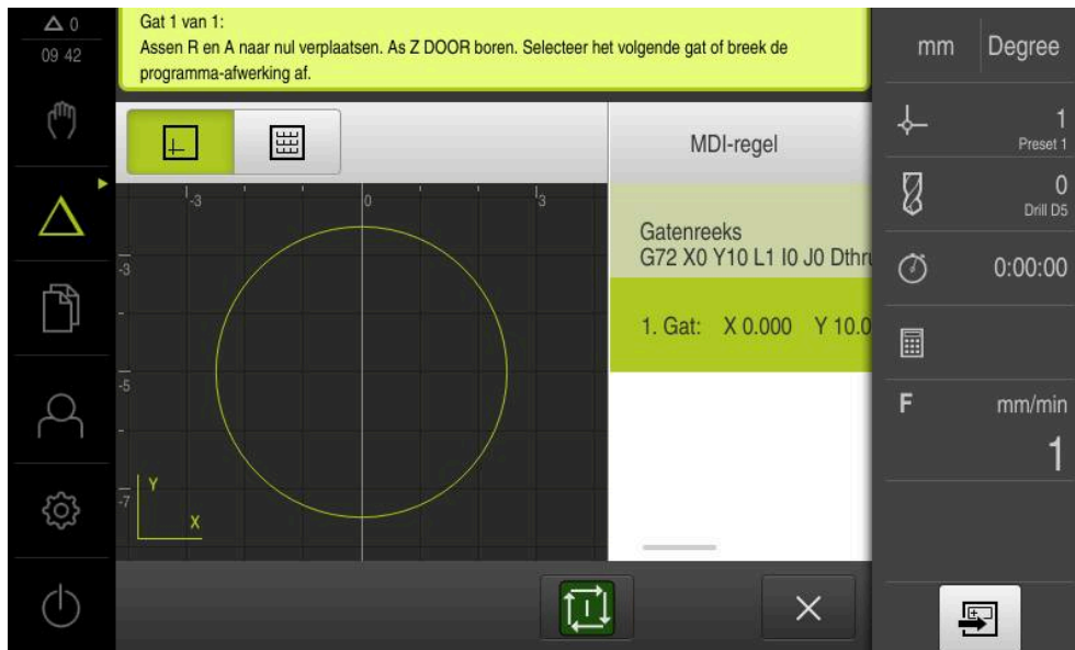
Afbeelding 61: Voorbeeld – uitvoering van een MDI-regel met schaalfactor
