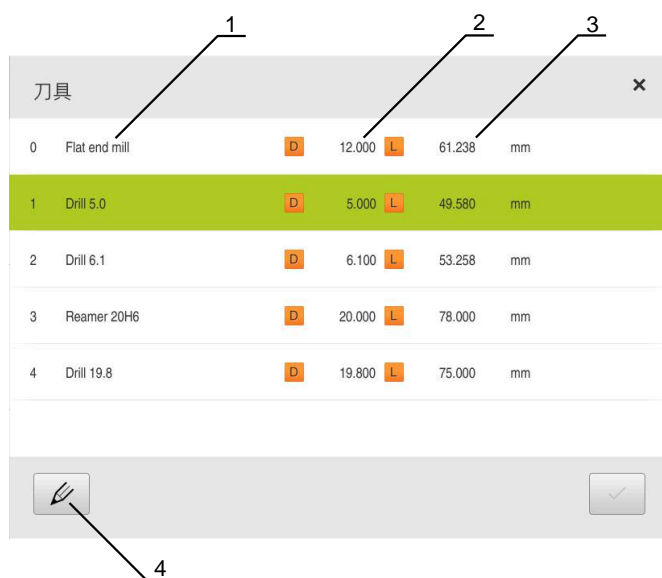
图 29: 带刀具参数的刀具表
