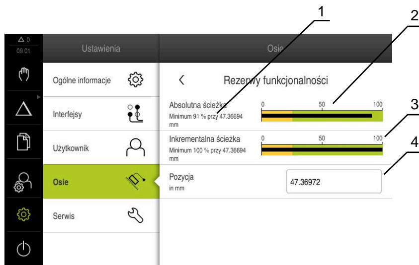
Ilustracja 33: Przykład rezerw funkcjonalności czujnika pomiarowego
