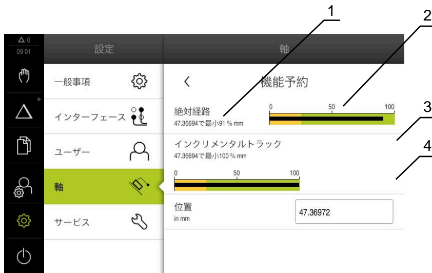
図 33: 測定プローブの機能リザーブの例
