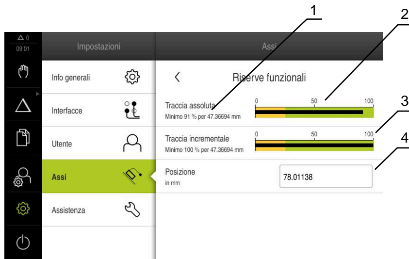
Figura 33: Esempio di riserve funzionali di un tastatore di misura
