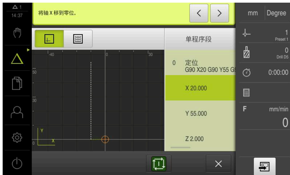
图 52: 举例 – 带缩放系数MDI程序段的执行
