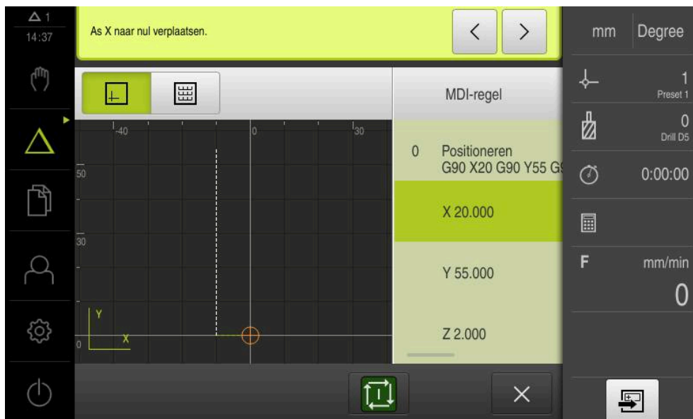
Afbeelding 52: Voorbeeld – uitvoering van een MDI-regel met schaalfactor
