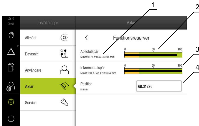
Bild 33: Exempel på en mätsonds funktionsreserver
