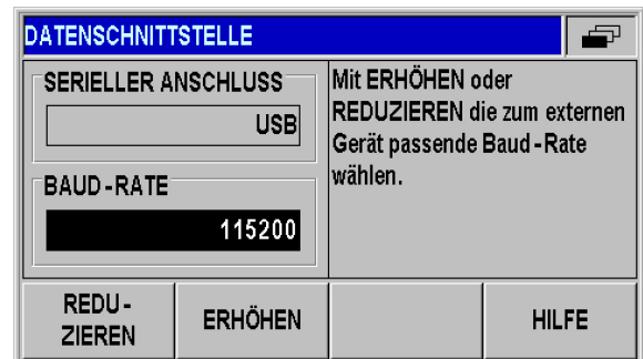
Abb. II.43 Datenschnittstelle USB (UART)
