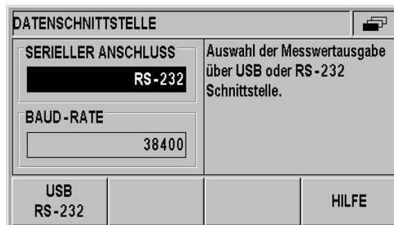
Abb. II.34 Datenschnittstelle V.24/RS-232-C
