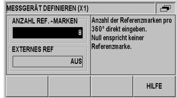
Abb. II.13 Eingabemaske für ein inkrementales Winkelmessgerät
