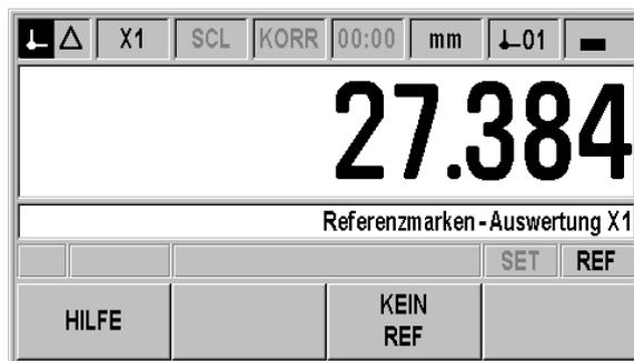
Abb. I.12 Anzeige bei der Ermittlung der Referenzmarken
