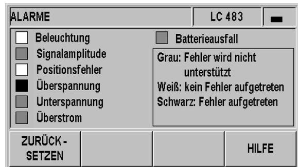
Abb. II.44 Messgeräte-Test: EnDat-Schnittstelle
