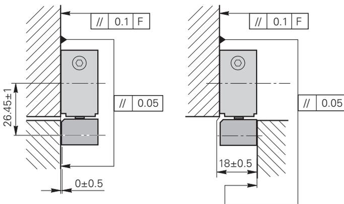
Toleranz zwischen Montagefuß und Maßstabsgehäuse:
