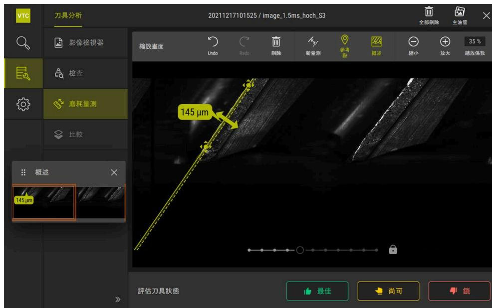
圖形 21: 側面磨損模式
