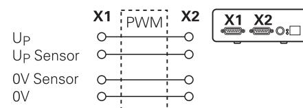
Beispiel 2 – Gerät versorgt das Messgerät über X1:
