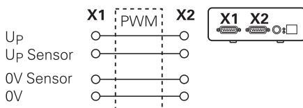
Ejemplo 2 – El equipo alimenta al sistema de medición a través de X1:
