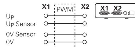
Příklad 2 – Přístroj napájí měřidlo přes X1:
