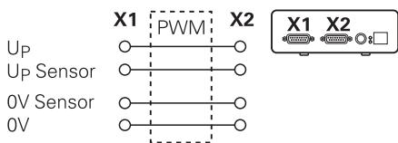
Esempio 2 – L'apparecchiatura alimenta l'encoder tramite X1:
