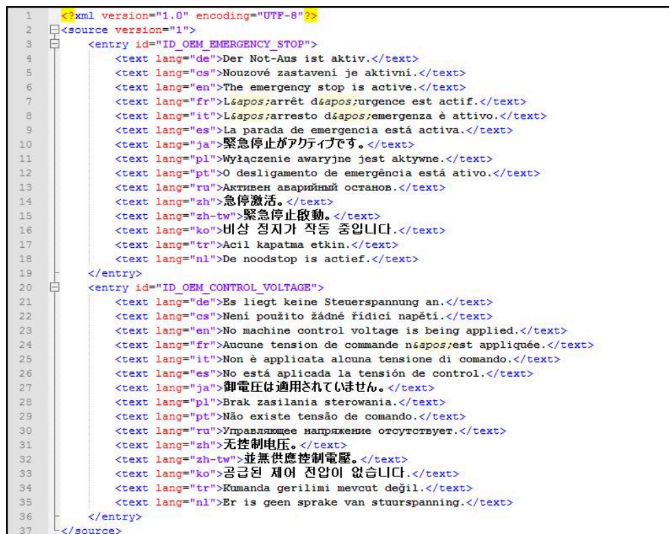
Afbeelding 27: Voorbeeld –XML-bestand voor tekstdatabase
