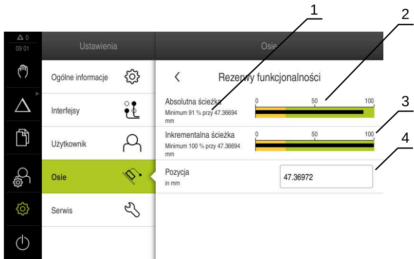
Ilustracja 31: Przykład rezerw funkcjonalności czujnika pomiarowego
