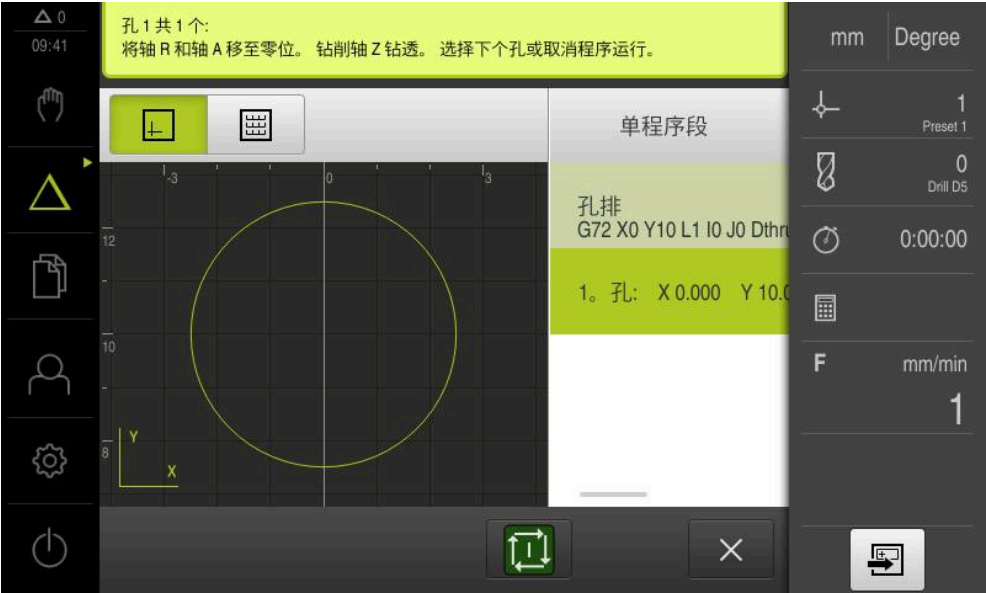
图 60: 举例 – 带缩放系数MDI程序段的执行
