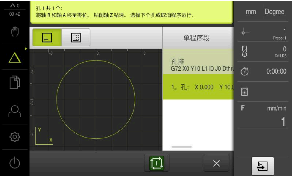
图 61: 举例 – 带缩放系数MDI程序段的执行
