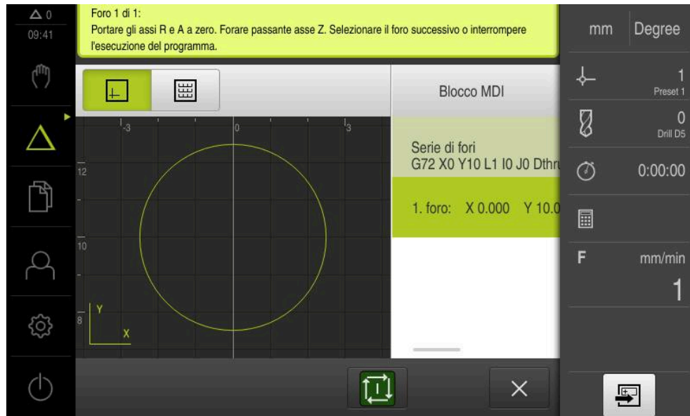
Figura 60: esempio – esecuzione di un blocco MDI con fattore di scala
