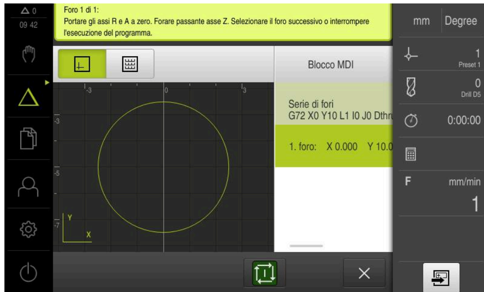
Figura 61: esempio – esecuzione di un blocco MDI con fattore di scala
