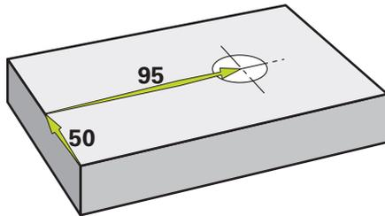
Figura 64: Pieza de ejemplo – Realizar orificio pasante
