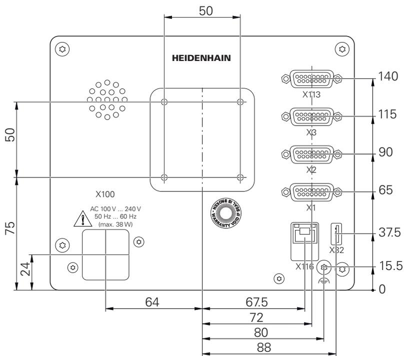
Figura 36: Cotas de la parte posterior del equipo con ID 1089178-xx
