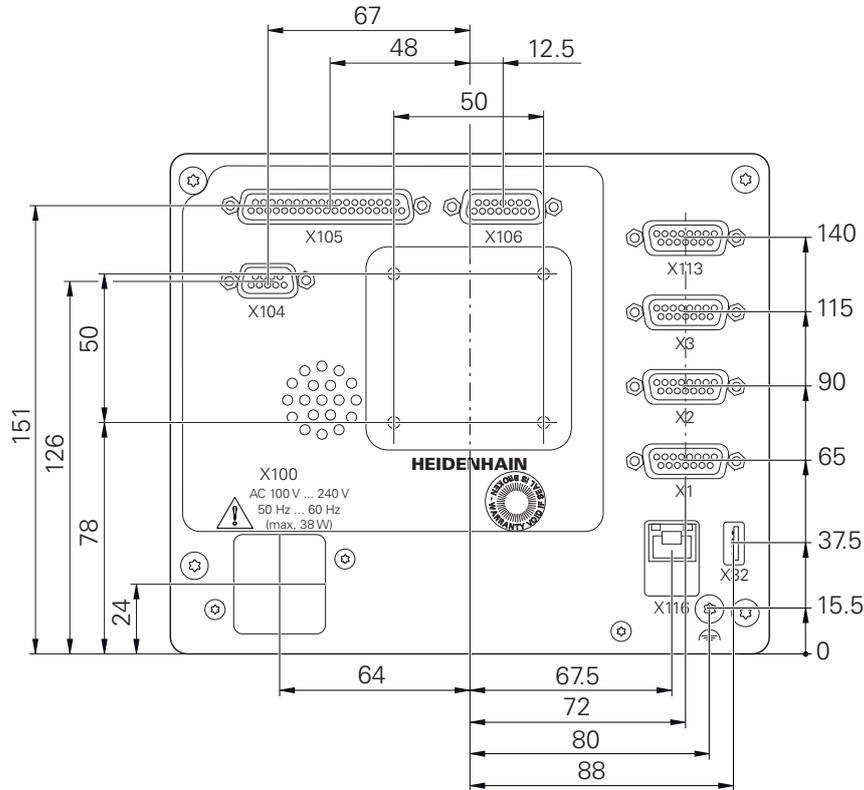
Figura 37: Cotas de la parte posterior del equipo con ID 1089179-xx
