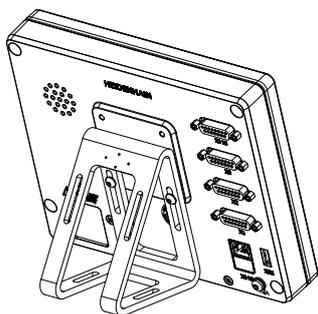
Figura 18: Dispositivo montado en soporte bisagra Duo-Pos
