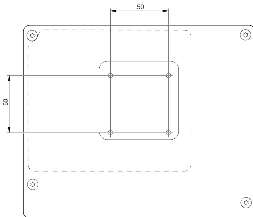
Figura 15: Mediciones de la parte trasera del equipo
