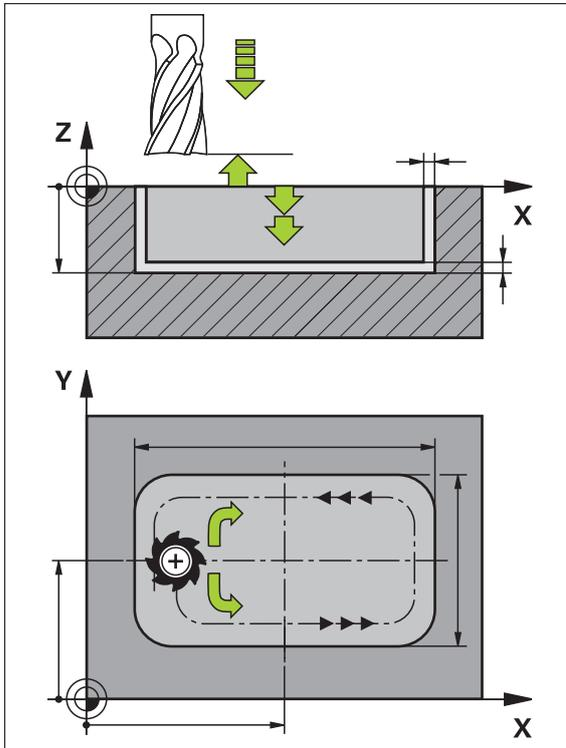
Figura 47: Representación esquemática de la frase Cajera rectangular
