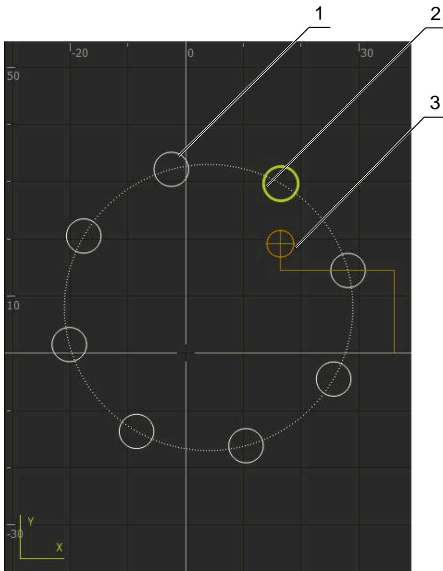
Figura 60: Ventana de simulación con vista de contorno
