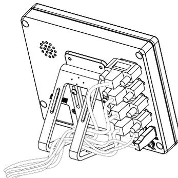
Figura 19: Cableado en soporte bisagra Duo-Pos
