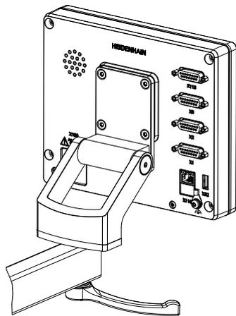
Figura 22: Dispositivo montado en soporte Multi-Pos
