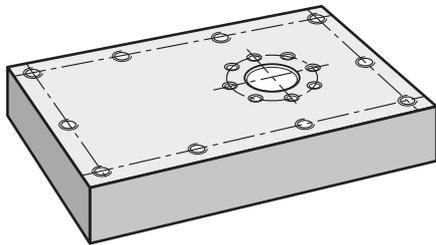
Figura 69: Pieza de ejemplo – Programar un círculo de taladros y una fila de taladros
