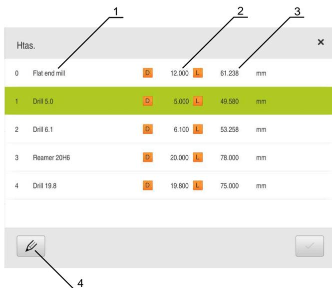
Figura 29: Tabla de herramientas con parámetros de herramienta
