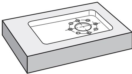
Figura 68: Pieza de ejemplo – Realizar círculo de taladros
