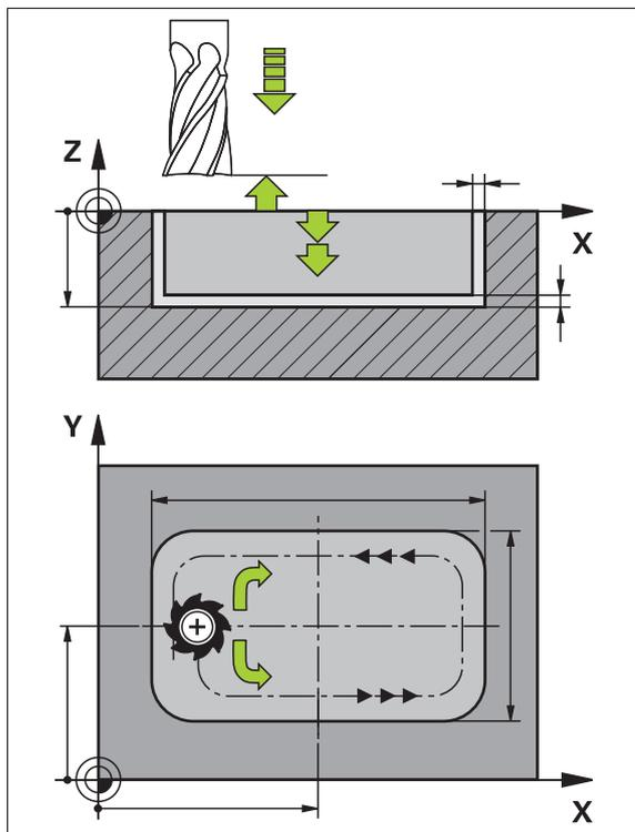
Figura 58: Representación esquemática de la frasa Cajera rectangular
