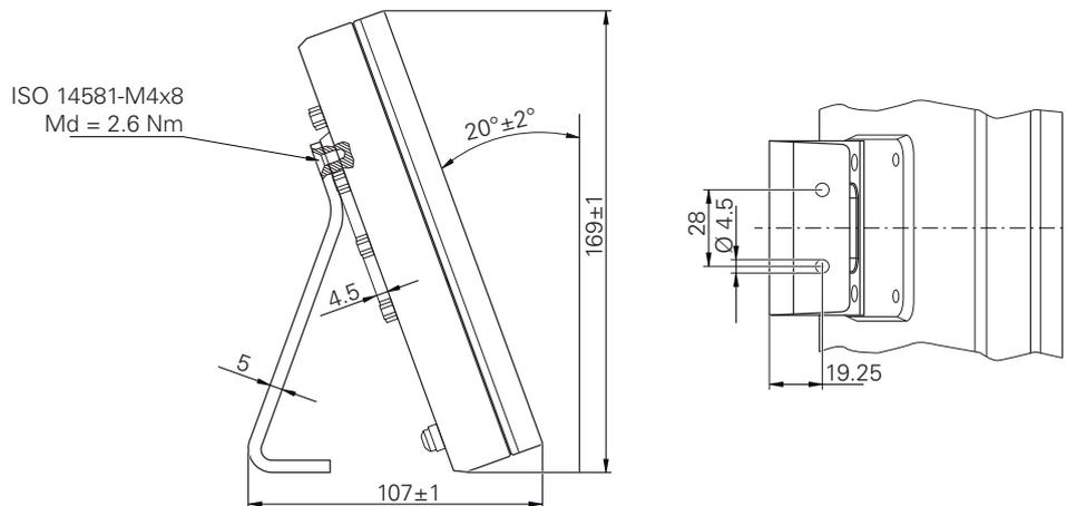
Figura 38: Medidas del equipo en soporte bisagra Single-Pos
