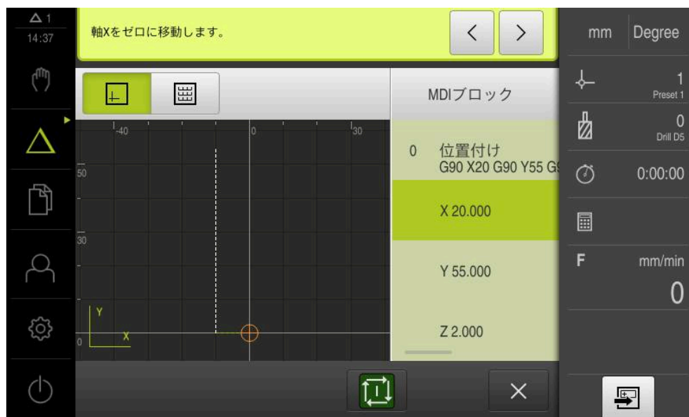
図 52: 例- スケーリングを使った MDI ブロックの実行
