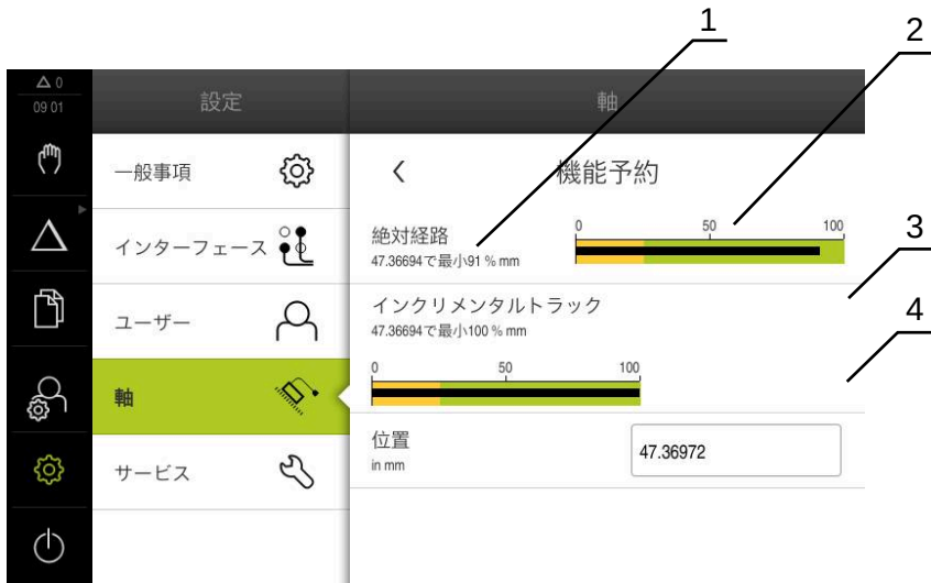
図 33: 測定プローブの機能リザーブの例
