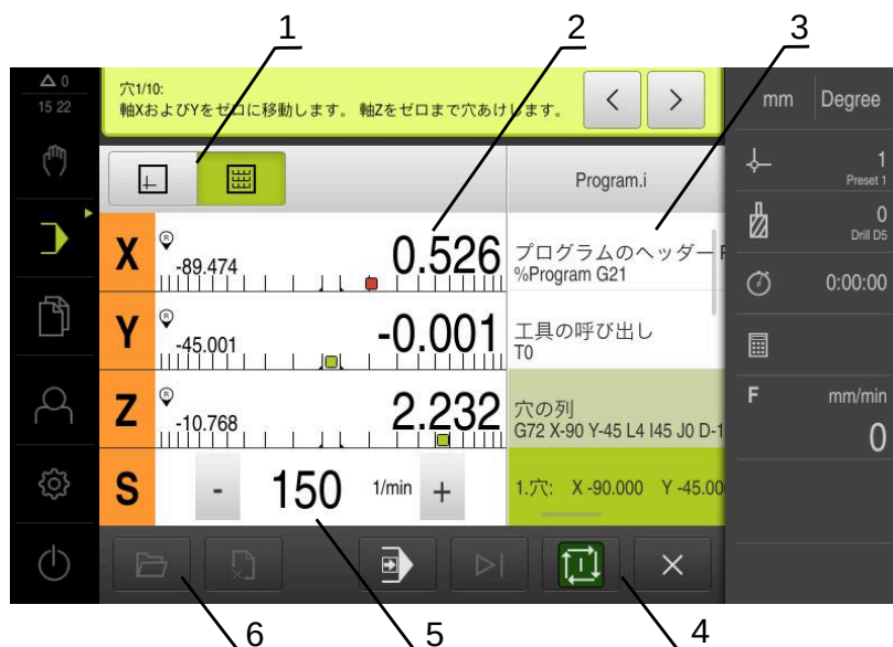
図 53: 「プログラムラン」操作モードのプログラム例
