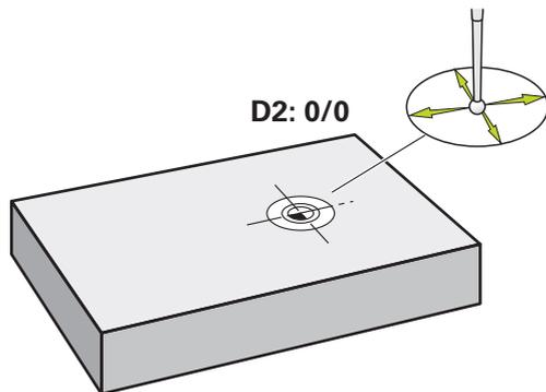
Figura 21: Pieza de ejemplo – Determinar punto de referencia D2
