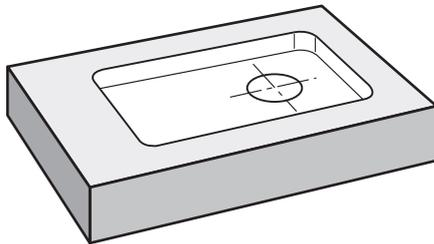
Figura 19: Pieza de ejemplo – Realizar cajera rectangular
