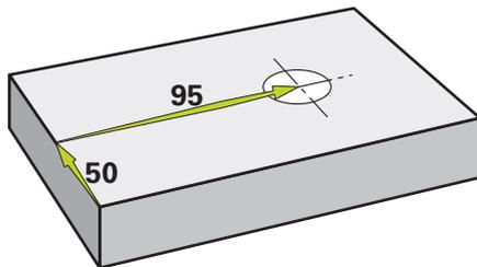
Figura 18: Pieza de ejemplo – Realizar orificio pasante
