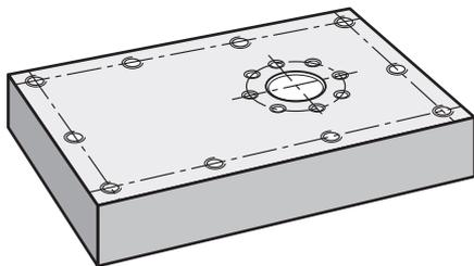
Figura 23: Pieza de ejemplo – Programar un círculo de taladros y una fila de taladros
