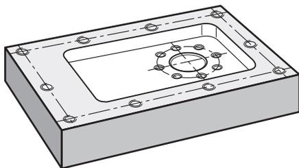
Figura 25: Pieza de ejemplo – Realizar un círculo de taladros
