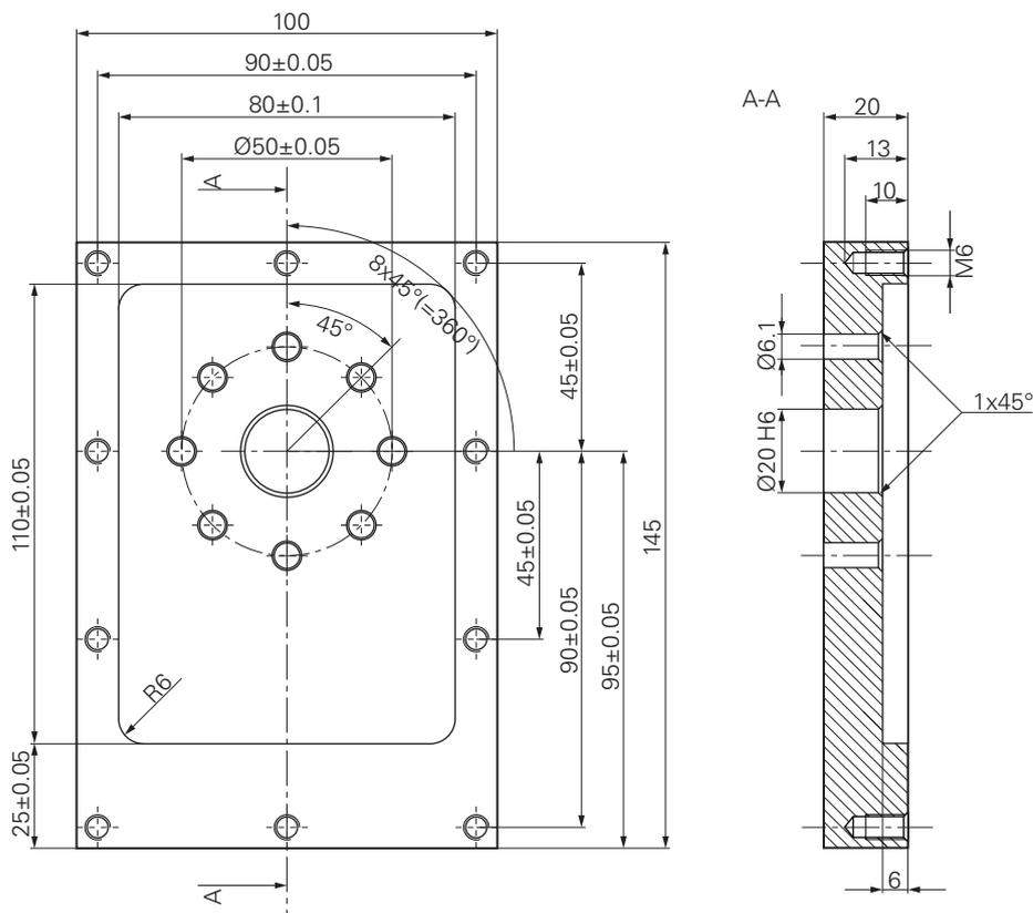
Figura 16: Pieza de ejemplo – Dibujo técnico
