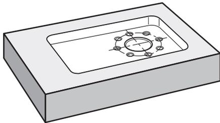
Figura 22: Pieza de ejemplo – Realizar círculo de taladros
