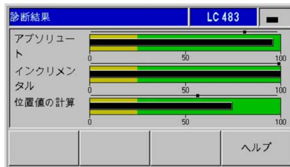
Abb. II.52エンコーダテスト : EnDat 2.2 インタフェース
