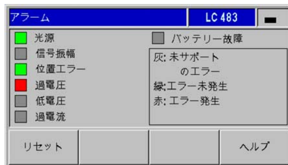
Abb. II.53エンコーダテスト : EnDat インタフェース
