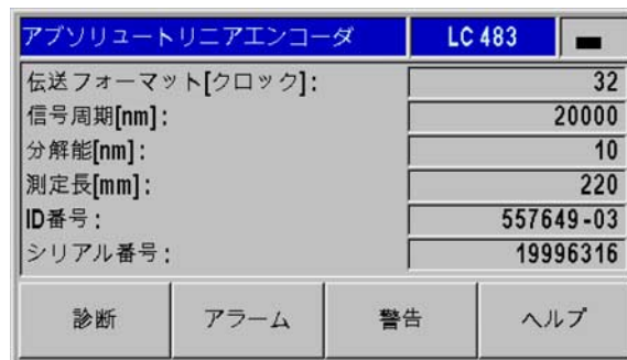
Abb. II.51エンコーダテスト : EnDat インタフェース
