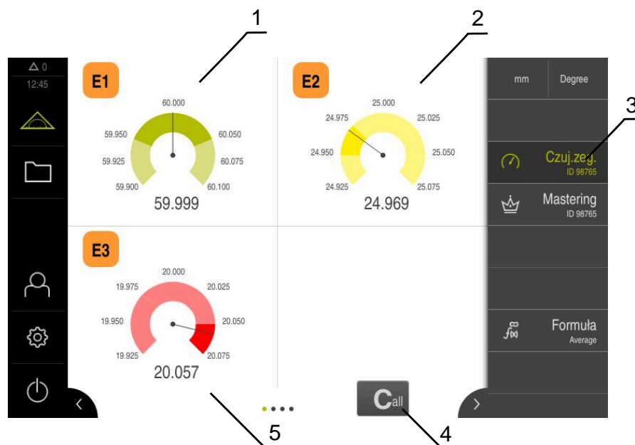
Ilustracja 46: Przegląd czujnik zegarowy
