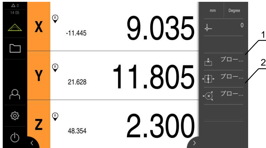
図 38: プロービング機能のための機能エレメントを含むツールバー
