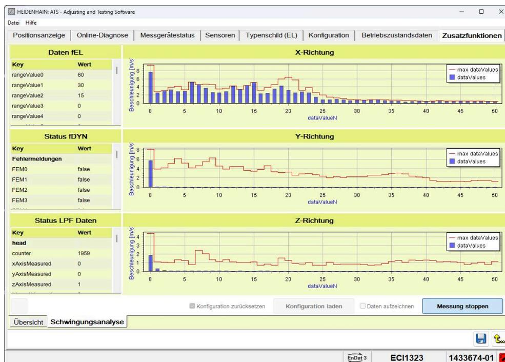
Abbildung 138: Ansicht **Schwingungsanalyse**
