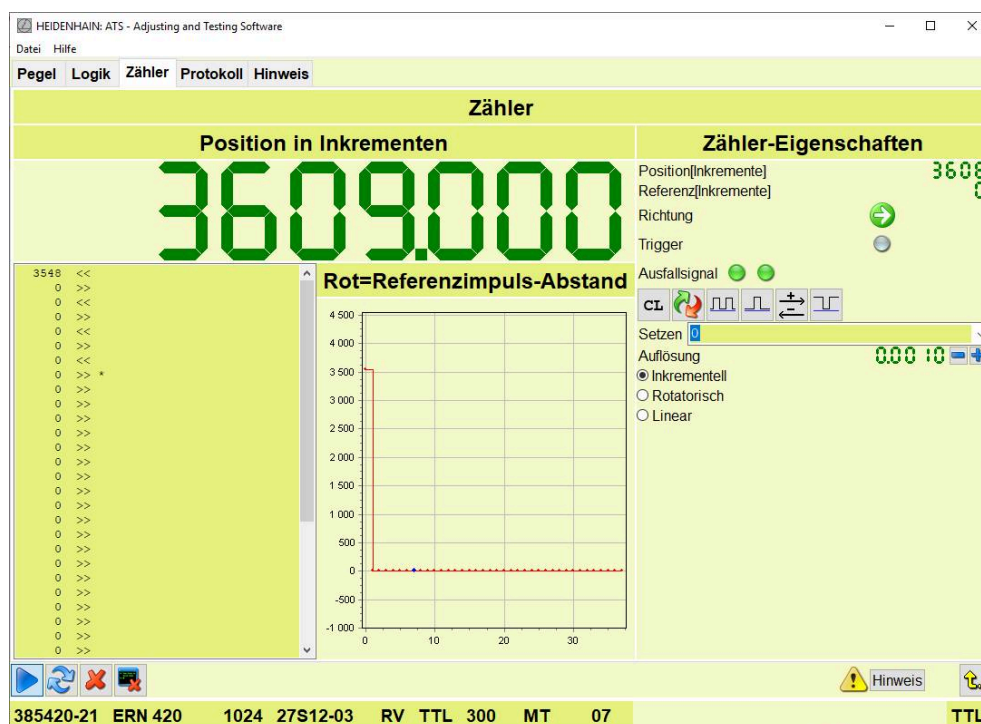
Abbildung 86: Funktion Inkrementalsignal mit der Ansicht Zähler
