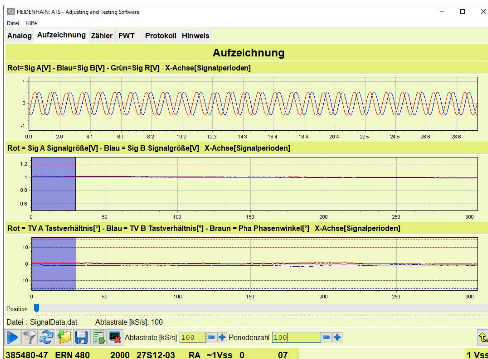
Abbildung 52: Aufgezeichnete Signalperioden ohne Fehler
