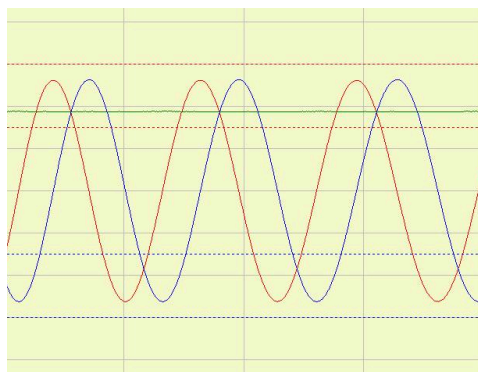
Ausreichend hohe Abtastrate mit korrekter Signalform
