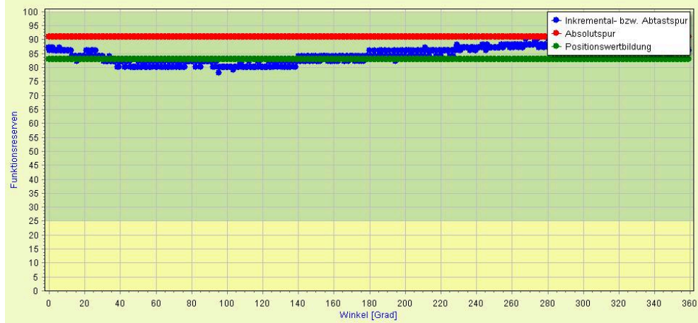
Abbildung 118: X/Y-Anzeige der Funktion Online-Diagnose
