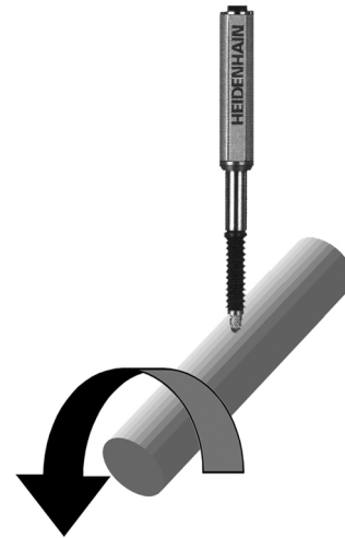
Medir el descentrado de un eje
