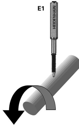
Dans un autre exemple, l'angle entre les points hauts de deux cames est calculé en faisant tourner l'arbre, en mesurant les angles de rotation des minimums de chaque came, et en soustrayant le petit angle du plus grand angle.
