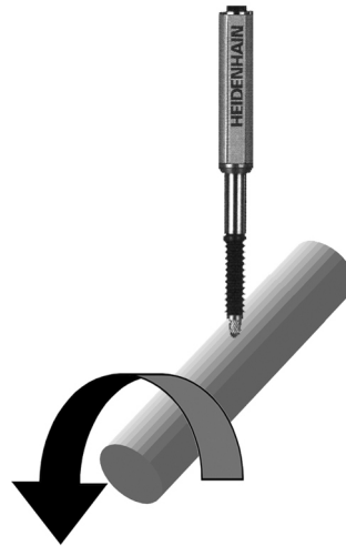
Messung des Rundlaufs einer Welle
