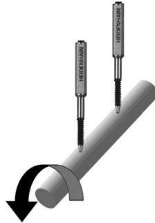
Kalibrierung von 2 Punkten auf einer Stange
