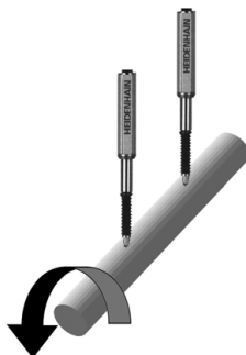
Calibrazione di due punti su una barra.
