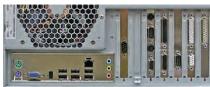
Carte PC typique et connecteurs des plaques de raccordement à l'arrière du PC
