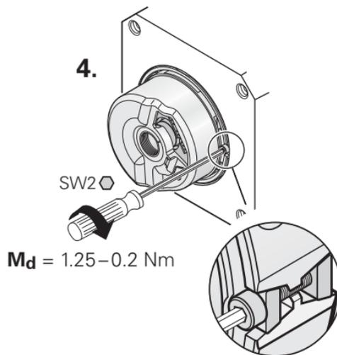
Die Aushärtezeit der stoffschlüssigen Losdrehesicherung der Zentralschraube beträgt 6 Stunden!
