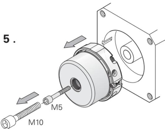
Im Ersatzfall Gewinde M5 nachschneiden und neue Schrauben mit Losdrehsicherung verwenden!
