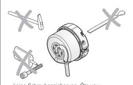
keine Schraubensicherung, Öle usw. No screw securer, oils, etc.
