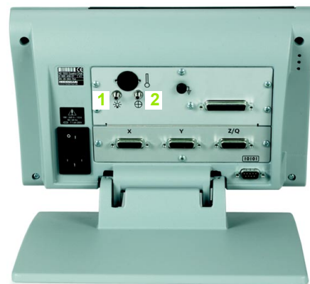
Abb. 2.9 Входы референтного и измерительного кабеля сенсора
