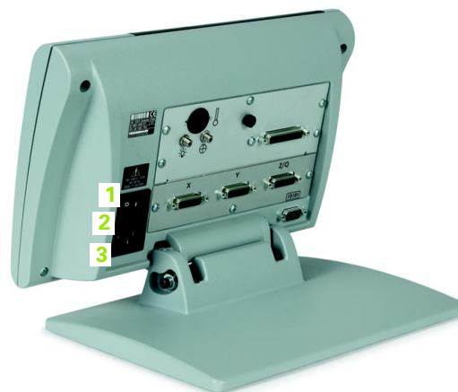
Interruptor de energia, fusível e conector
