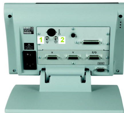
Abb. 2.9 Wejścia referencyjne i wejście kabla czujnika
