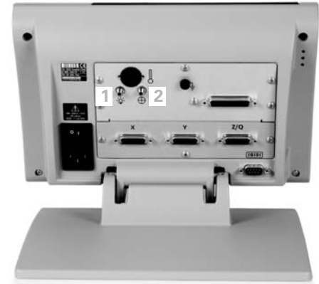
Aansluitingen voor de referentiekabel en sensorkabel
