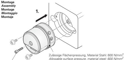
Pression admissible de surface, matière acier: 600 N/mm<sup>2</sup> ECN: ISO 4762 M3 x 20 - A2 Pressione superficiale ammissibile, materiale acciaio: 600 N/mm<sup>2</sup> EQN: ISO 4762 M3 x 30 - A2 Presión superficial admisible, material acero: 600 N/mm<sup>2</sup>
