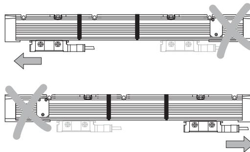
Schrauben und Dichtlippenklemmstück **O** aufbewahren.
