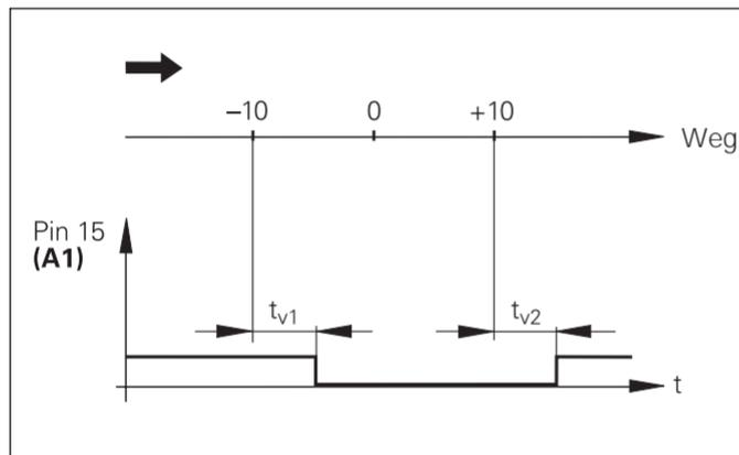
Zeitlicher Signalverlauf für Schaltgrenze (A1) = 10 mm,  $t_{v1} \leq 30$  ms,  $t_{v2} \leq 180$  ms
