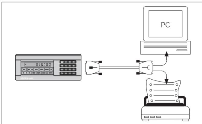
An die Datenschnittstelle V.24/RS-232-C (X31) lässt sich ein Drucker oder ein PC anschließen.
