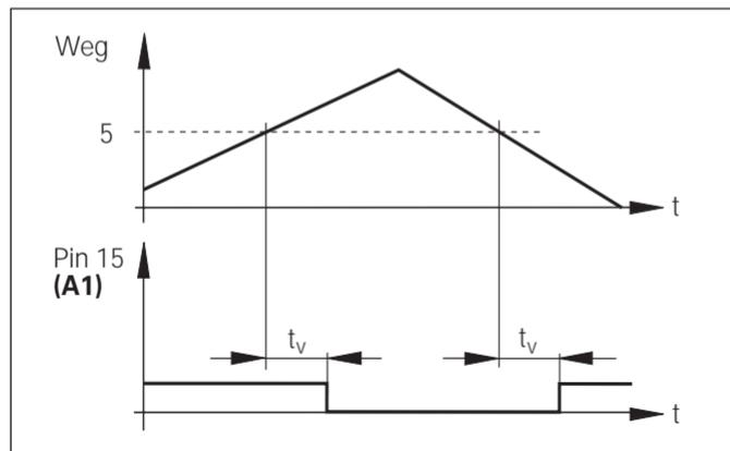
Zeitlicher Signalverlauf an Pin 15 für Schaltgrenze (A1) = 5 mm,
