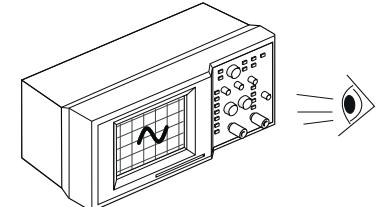
Durch Drehen des Abtastkopfes die Ausgangssignale auf größtmögliche Amplitude optimieren. Danach Befestigungsschrauben anziehen.
