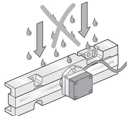
Anbau so wählen, dass der maximale Verfahrweg innerhalb der Messlänge ML des Maßstabs liegt. Bei Überschreitung kann schädliche Laserstrahlung austreten!
