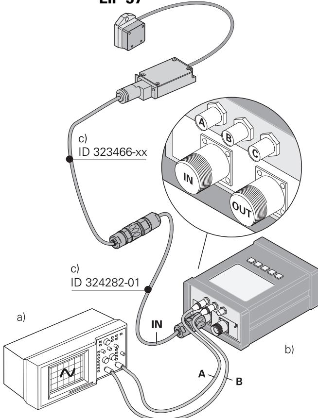
Zur Prüfung der Ausgangssignale Maßstab hin- und herfahren.
