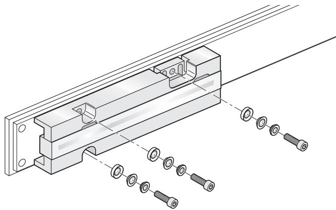
Ausrichtung des Maßstabs zur Maschinenführung F überprüfen.
