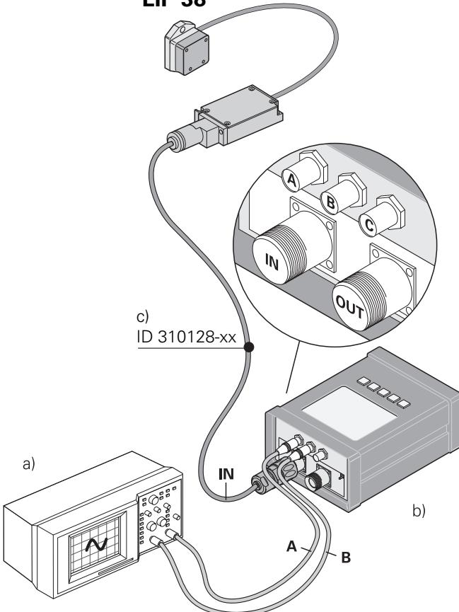
Zur Prüfung der Ausgangssignale Maßstab hin- und herfahren.
