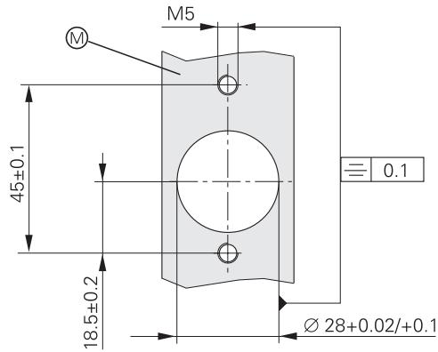
Abtastkopf lose anschrauben.
