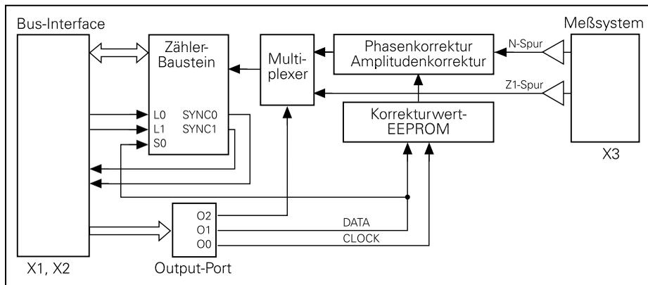
Die Zählerkarte IK 410 V besitzt ein an den ISA-Bus angelehntes Interface (Stecker X1 und X2), d.h. 16-Bit-Datenbus, 6-Bit-Adreßbus, sowie die Signale -RD, -WR, -CS, -RESET und INTERRUPT.
