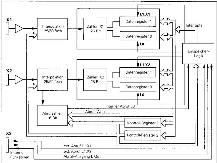
Die Interpolations-Elektronik in der IK 120 unterteilt die Signalperiode des Eingangssignals bis zu 200fach.
