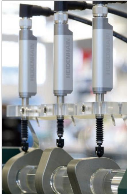
Prüfstation zur Ebenheitskontrolle
